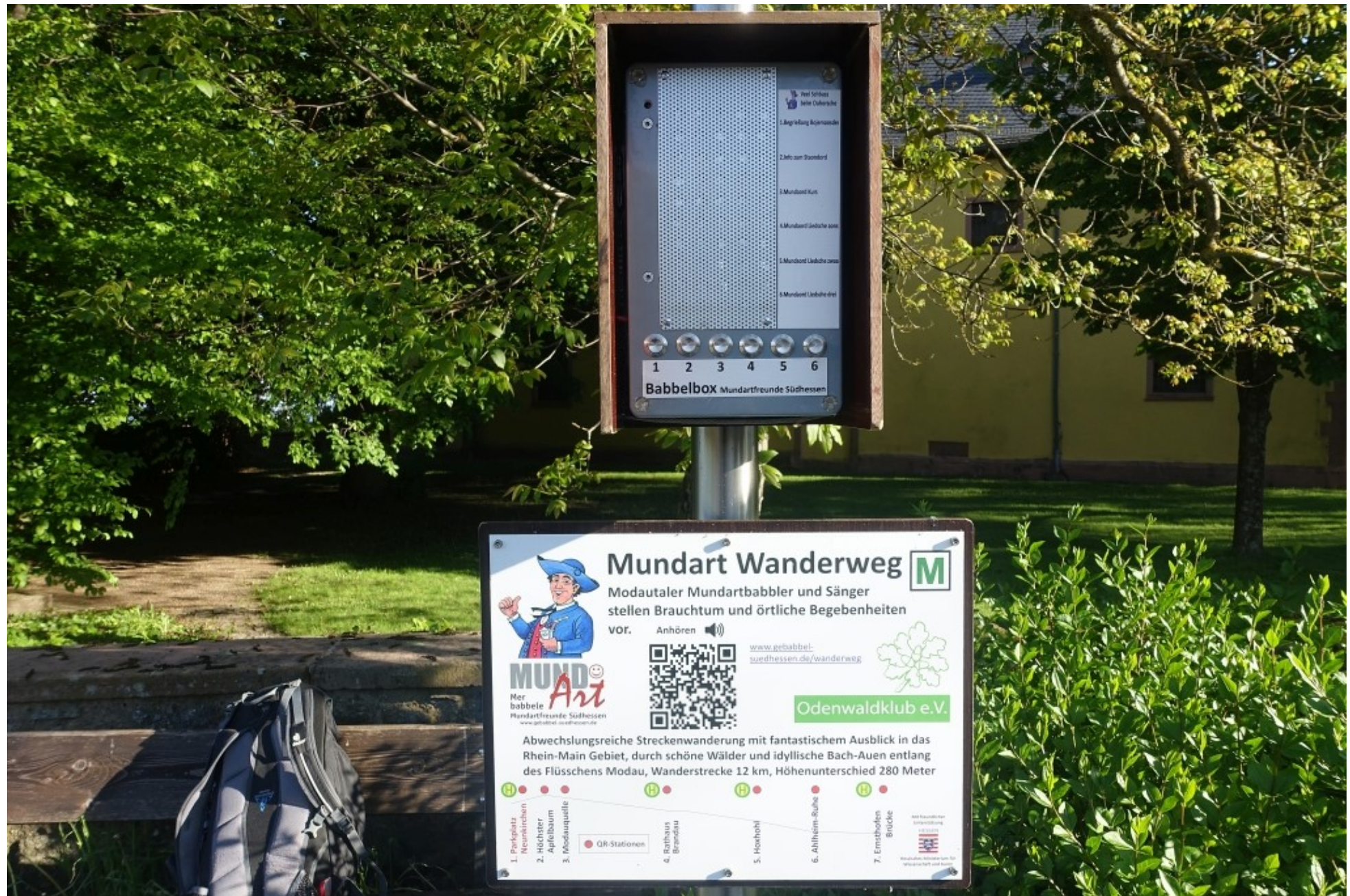
Ein Unikat am Startpunkt: die Babbelbox, gespeist mit Solarenergie und ausgestattet mit einem Dämmerungsschalter, um zu vermeiden, dass des Nachts der Weiler Neunkirchen beschallt wird.
